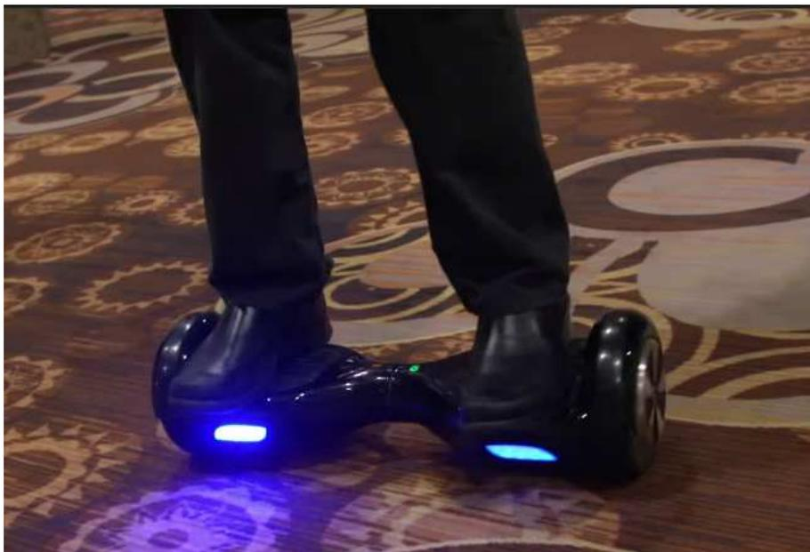
Mit einer Höchstgeschwindigkeit von **10 km/h** reicht eine Akkuladung für **16-19 km**. Ein erneutes Wiederaufladen dauert nur 3 Stunden und ist an jeder Steckdose möglich.
