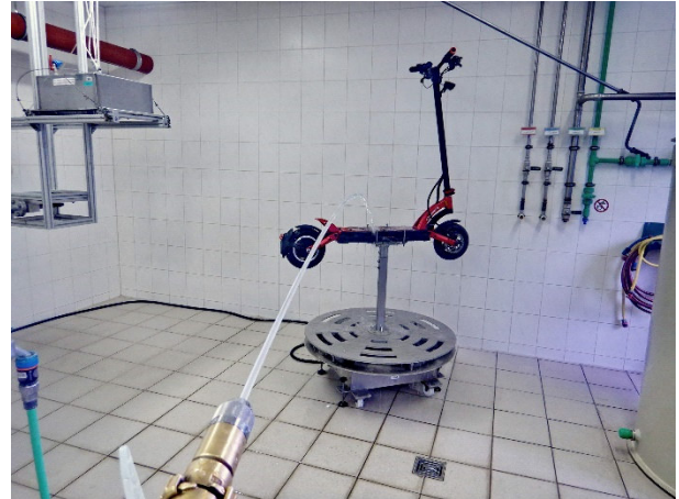
Bild 2 Prüfling mit genormter Strahldüse und mit genormtem Strahlwasser am Prüfbereich während der Strahlwasserschutzprüfung IPX5
