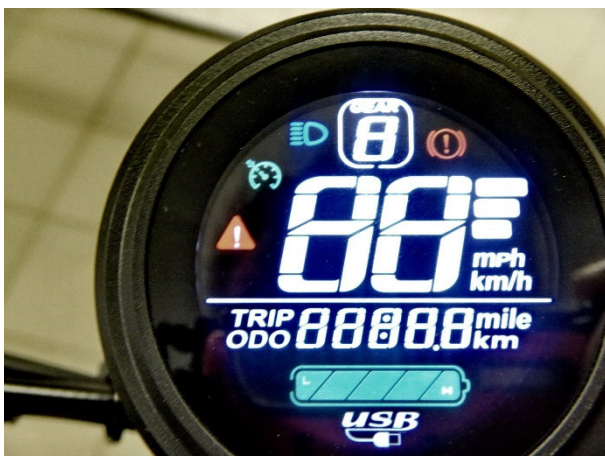
Bild 5 Prüfling (Steuergerät) keine erkennbaren Funktionsmängel nach der Strahlwasserschutzprüfung IPX5
