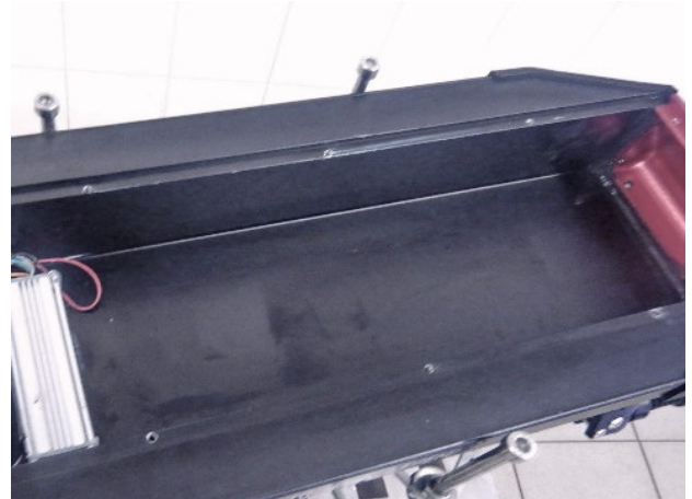
Bild 6 Prüfling (Deck geöffnet) keine erkennbaren Wasserspuren im Akkugehäuse nach der Strahlwasserschutzprüfung IPX5
