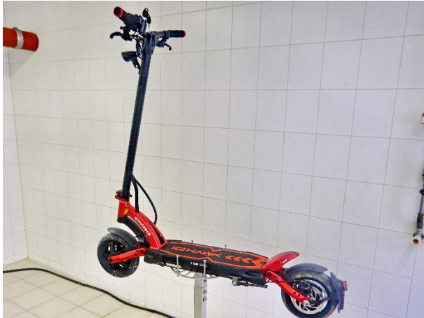
Bild 1 Prüfling auf dem Drehtisch am Prüfgestell montiert vor der Strahlwasserschutzprüfung IPX5
