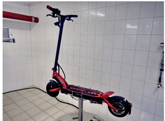
Bild 4 Prüfling ohne erkennbare äußerliche Mängel nach der Strahlwasserschutzprüfung IPX5
