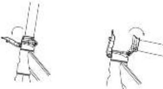
3. Stellen Sie vor dem Zusammenklappen sicher, dass der Scooter ausgeschaltet ist. Drücken Sie die Schnalle wie in der Abbildung gezeigt und ziehen Sie den Hebel nach unten.
